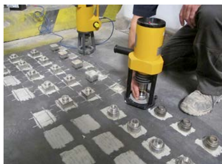
(3) Prüfungen zur Ermittlung der Oberflächenzugfestigkeit (runde Prüfstempel) und Haftzugfestigkeit (Haftung von zwei Schichten – quadratische Prüfstempel)
