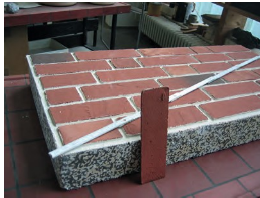
Bild 2. Dämmplatte mit aufgeklebten Klinker-Riemchen (Foto: Gigla)
