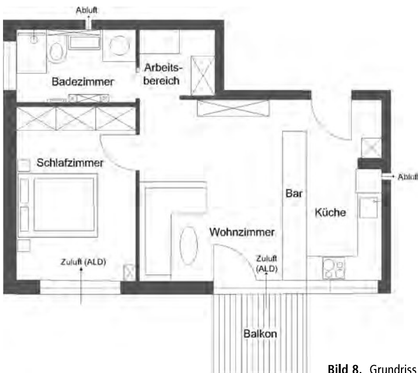
Bild 8. Grundriss und Raumaufteilung der Testwohnung
