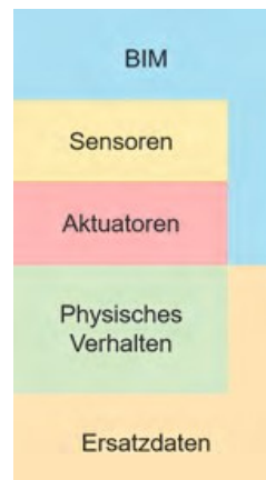
Bild 2. Schematische Gliederung des digitalen Gebäudezwillings
