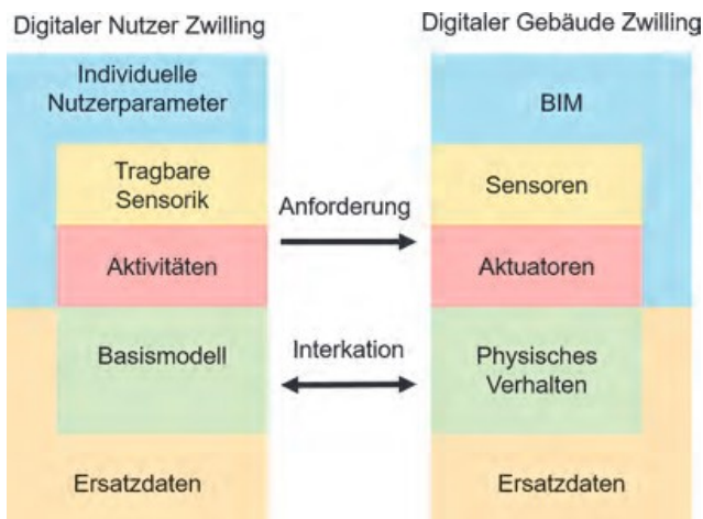
Bild 4. Interaktionsmodell digitaler Gebäude- und Nutzerzwillings
